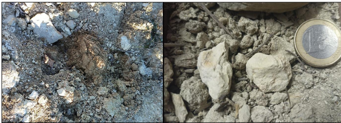
Figura 70. A sinistra un confronto tra una zolla di terreno evoluta (in centro, rossastra) e zolle non evolute. Si noti la brunificazione con comparsa di ossidi, la rimozione della calcite e la struttura a blocchi. A sinistra la formazione di glomeruli di calcare (i due in centro) per carbonatazione. Può avvenire sia in terreni non evoluti che in suoli evoluti.
